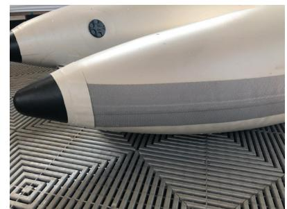
Wärmeänderungen im Tagesverlauf prüfen Sie unbedingt die Druckwerte aller luftgefüllten Komponenten und korrigieren Sie sie auf die korrekten Druckwerte, um Beschädigungen zu vermeiden. Der Hochdruckboden ist nicht mit einem Überdruckventil ausgestattet. Vermeiden Sie deshalb eine zu intensive Sonneneinstrahlung auf den Hochdruckboden und überprüfen und korrigieren Sie gegebenenfalls die Druckwerte.
