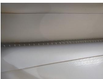
**Hinweis – Fixierungsnaht:** Wenn Sie die Fahrschläuche aufgepumpt haben werden Sie eine aufgetrennte Naht erkennen. Diese Naht ist kein Mangel sondern eine sogenannte Fixierungsnaht, die während der Fertigung gesetzt wird damit der Verbindungsbody im rechten Winkel mit den beiden Fahrschläuchen verklebt werden kann. Beim Aufpumpen öffnet sich diese Fixierungsnaht und die aufgetrennten Stichfäden sind zu erkennen, die sich im Laufe der Zeit wegreiben.
