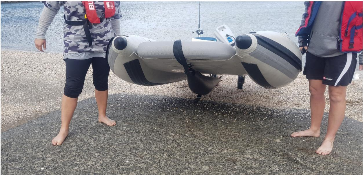
Der Speed-Tube wird im aufgeblasenen Zustand (250mbar / 3,6PSI) unter dem Verbindungsboden an den Ringen der Bugfixierung befestigt und zusätzlich mit den beiden mitgelieferten Spanngurten an der unteren Transomstange, links- und rechtsseitig der Heckspiegelplatte, mittig fixiert.
